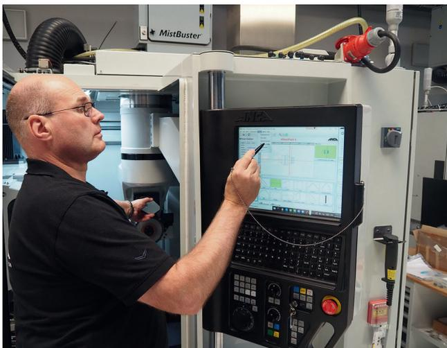
3 Über den 'WheelServer' von Anca lassen sich alle relevanten Schleifscheibeninformationen austauschen – Durchmesser, Scheibradius, Scheibwinkel, Flanschmaß und weitere © Anca
