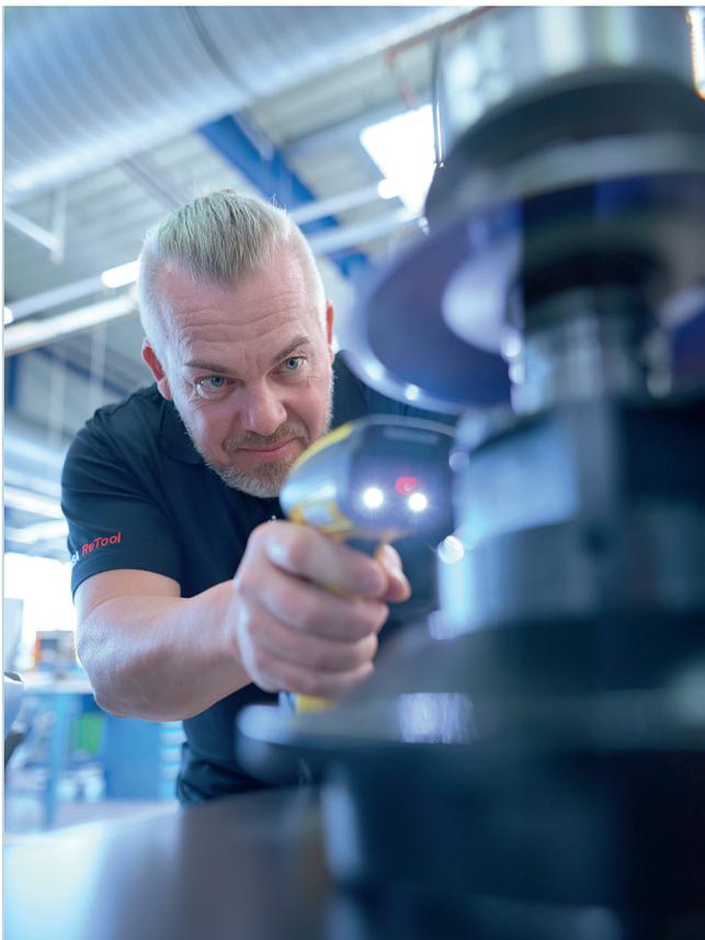
1 Bei Fraisa in Willich werden jedes Jahr 350 000 Werkzeuge aufbereitet. Die automatisierte Übertragung von Schleifscheibeninformationen und Messergebnissen zwischen den Schleifmaschinen von Anca und den Messmaschinen von Zoller verkürzt die Nebenzeiten um 20 Prozent
